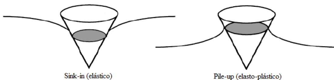
Figura 13. Fenômeno de sink-in e pile-up (21)
